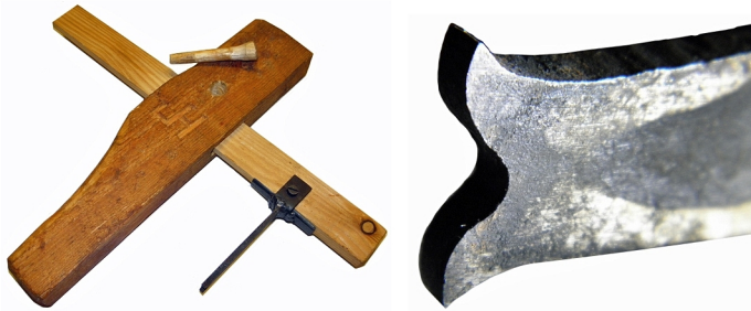
Parrunveistoa varten uustuotantona tehty vara ja sen kärki. Kun toinen sivu on saatu veistettyä suoraan, niin vastakkainen puoli puusta voidaan varata eli vetää kuoreen veistoviiva parruvaralla.
